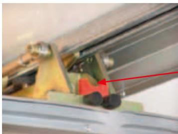
Bloqueo de seguridad (intercambiable) posicionado a 90 °C, costes de mantenimiento reducidos.
