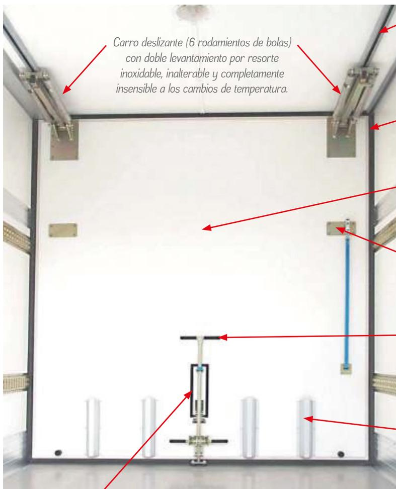
Carro deslizante (6 rodamientos de bolas) con doble levantamiento por resorte inoxidable, inalterable y completamente insensible a los cambios de temperatura.
